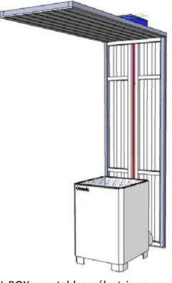
Câble élec. 5 fils 400V-3N triphasé (non fourni) du boîtier de connexion électrique « CONTROL BOX » au tableau électrique
